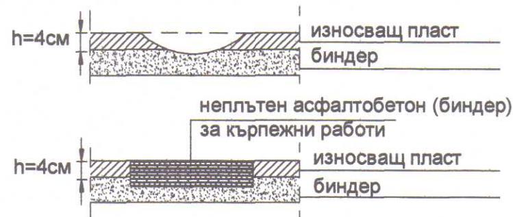
ДЕТАЙЛ No4 -Изкърпване на дупки
