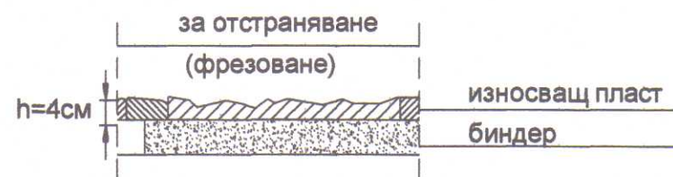
ДЕТАЙЛ No1 - Фрезование на повредени площи
